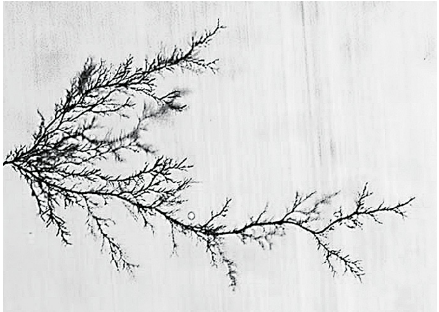
Rys. 4. Tworzenie się dendrytów (proces rozgałęziania) na izolatorze wzdłuż ścieżki upływu
