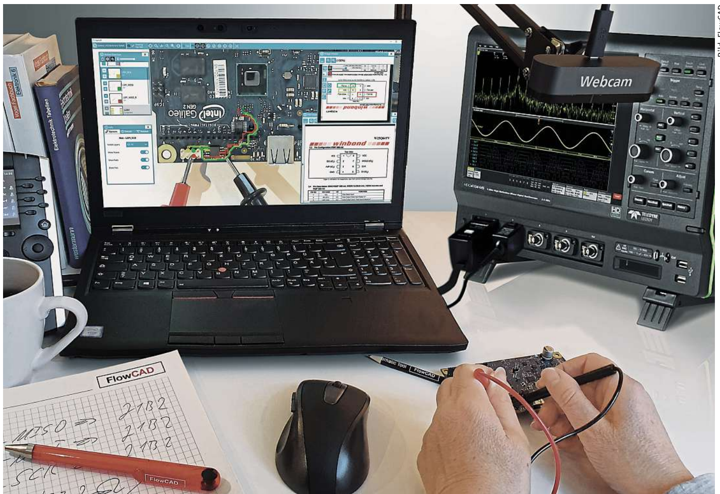
Bild 1: Schaltplan, Signalverläufe, Pin-Belegung, Datenblätter und Dokumentationen werden als Overlay eingespielt.
